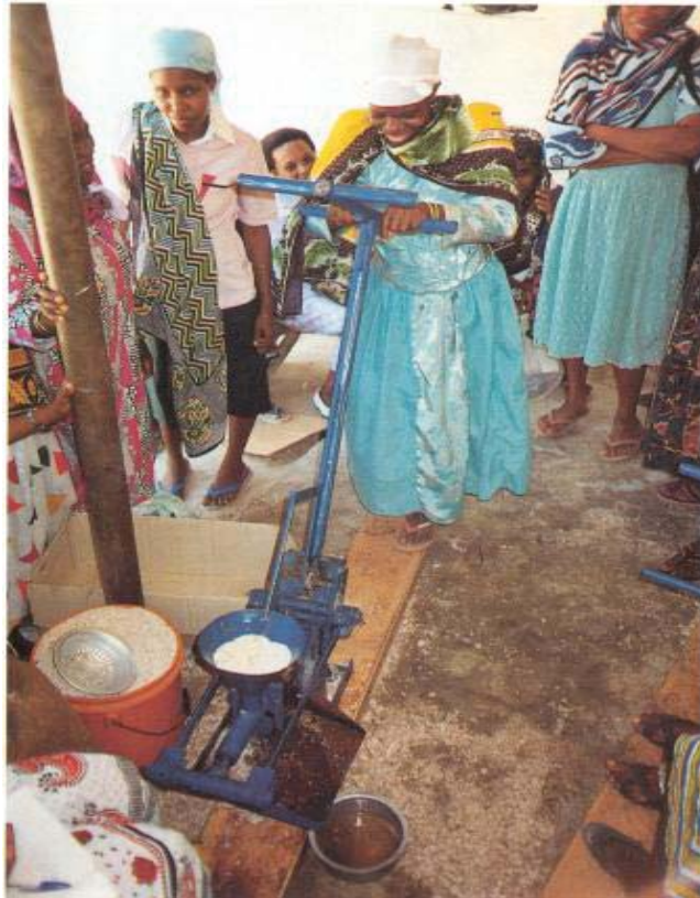
Kielelezo namba 23: Kukamua ufuta kwa mashine ya Ram
