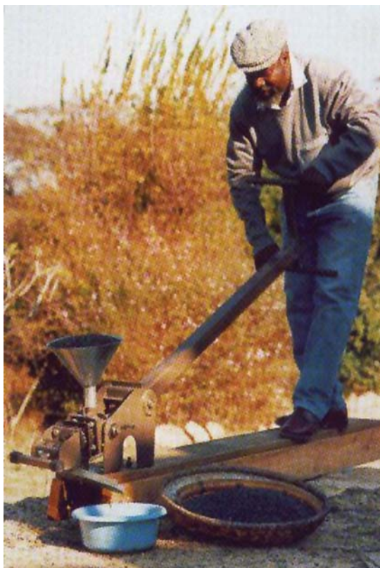
Kielelezo namba 8: Kukamua mafuta ya karanga kwa kutumia mashine aina ya Ram
