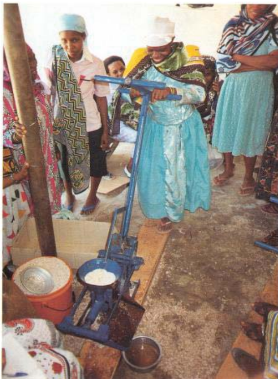
Kielelezo namba 34: Mashine ya mkono ya aina ya Ram ikitumika katika kukamua mafuta
